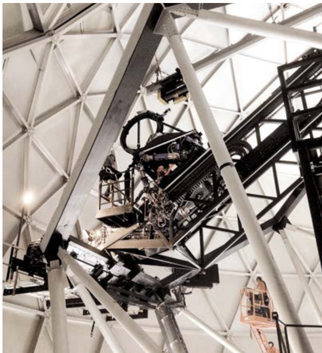
Fig. 8: Aufrüstung des Hobby-Eberly-Teleskops mit einer Weitwinkel-optik im Primärfokus, in die auch die VIRUS-Glasfaserbündel integriert sind. Upgrade of the Hobby-Eberly Telescope with a wide-field optics at its prime focus, where the VIRUS fibre bundles are located (Credit: McDonald Observatory).
