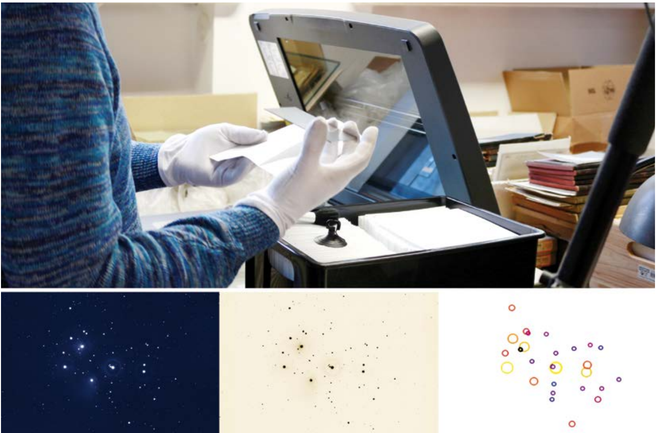
Fig. 2: Fotoplatten werden gescannt (hier von den Plejaden) und verarbeitet, um automatisch Objektkataloge zu erstellen. In der unteren rechten Abbildung sind die gefundenen Objekte skizziert. The photo plates were scanned (in this image the Pleiades) and processed to automatically generate object catalogs. In the bottom right picture the found objects are drawn. (Credits: AIP/K. Riebe)
