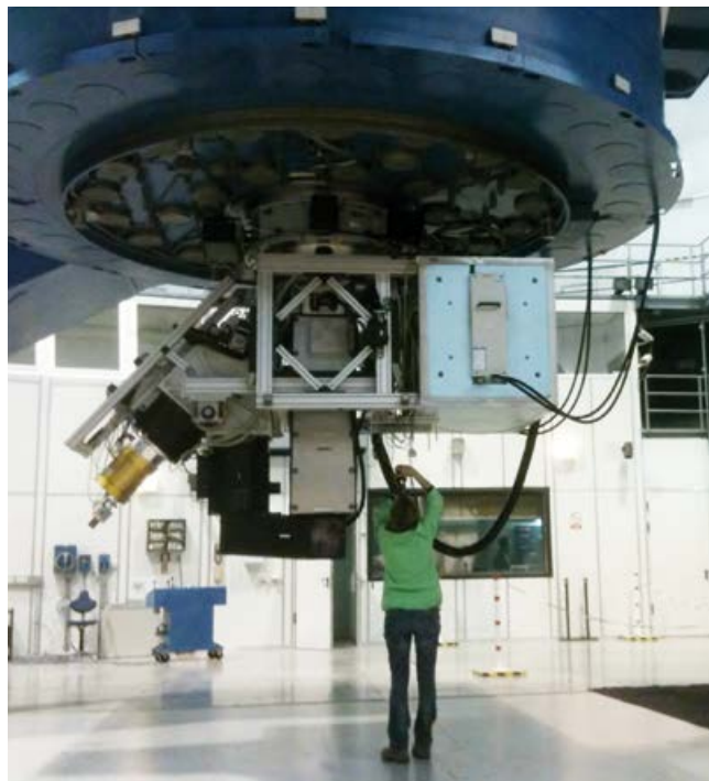
Fig. 9: Die Fasern des Laser-Frequenzkamms sind an das PMAS-Instrument des 3,5 m Teleskops auf dem Calar Alto in Spanien gekoppelt. The fibres of the Laser-Frequency Comb are coupled to the PMAS instrument, mounted at the Calar Alto 3.5 m telescope, Spain.
