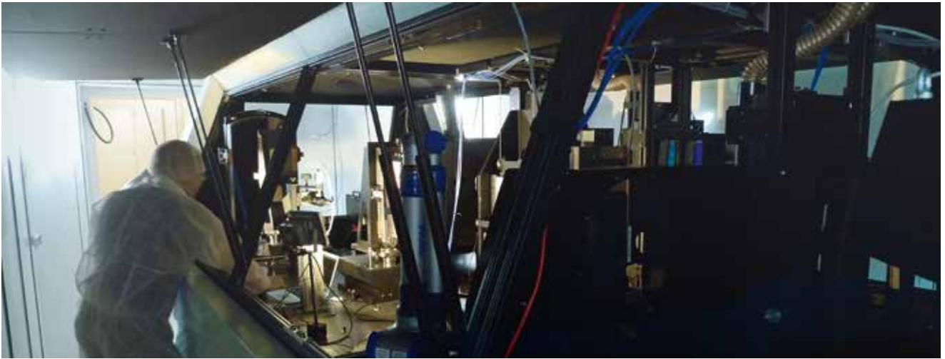
Fig. 1: Innenansicht des PEPSI Spektrografen während der Justagearbeiten. Inside view of the PEPSI spectrograph during alignment.
