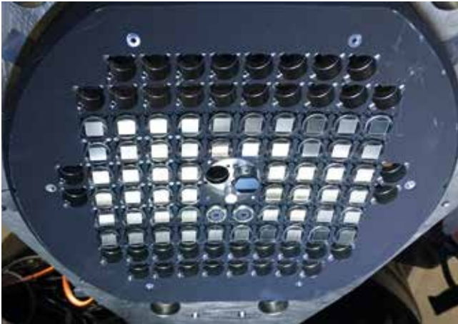
Fig. 7: Detailansicht der Fokalebene am Hobby-Eberly Teleskop mit den montierten 54 Faserbündelköpfen. Detailed view of the Hobby-Eberly telescope focal plane, featuring the input heads of 54 integral-field-units.
