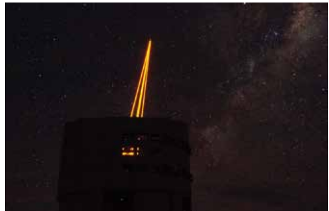
Fig. 1: Ein Foto des VLT Teleskop Nr. 4 mit angeschaltetem Lasersternsystem. A photo of VLT UT4 ("Yepun") with the laser guide stars active. (Credit: Peter Weilbacher)
