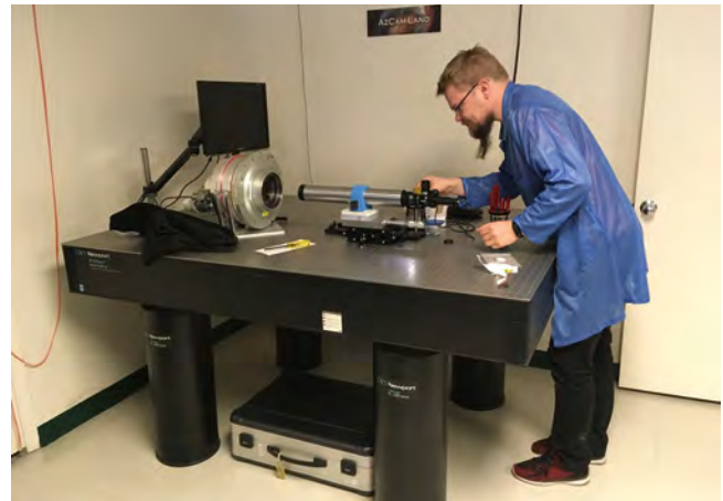
Eine der beiden PEPSI CCD-Kameras bei der Qualitätskontrolle nach dem Austausch der Ausleseelektronik. One of the two PEPSI CCD cameras during quality check after replacing the readout electronics. (Credits: AIP)
