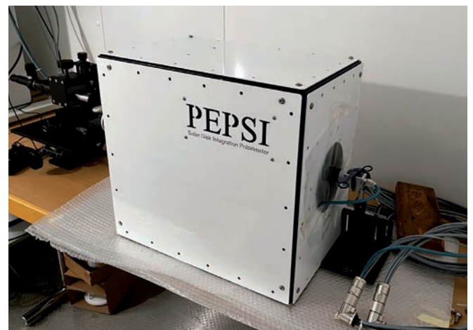
Das Sonnenscheibenteleskop (SDI-POL) im Physiklabor des AIP bei der Überprüfung des Betriebs bei den am LBT-Standort erwarteten tiefen Temperaturen von bis zu -10^\circ .
