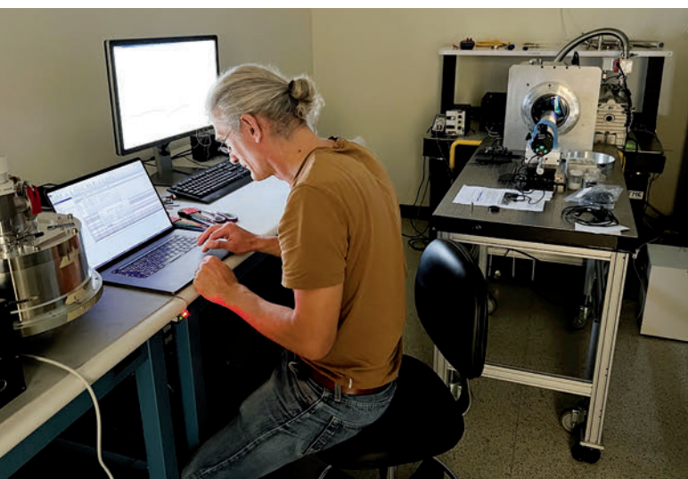
▲ Testen und Korrigieren der Ausrichtung der beiden neuen PEPSI-CCD-Detektoren in den vorhandenen Dewars im Labor des Herstellers in San Clemente, Kalifornien
