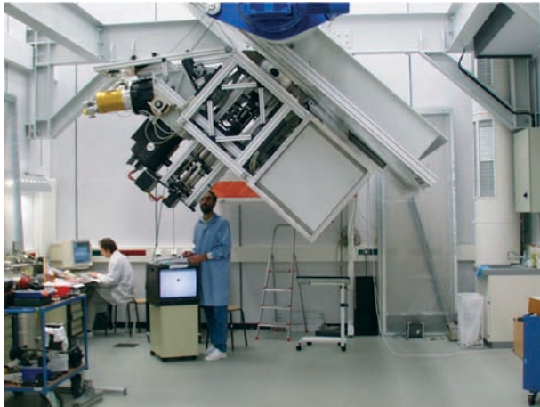
Abbildung 88: Testmessungen zur Untersuchung von Durchbiegungseffekten am Teleskopsimulator der Integrationshalle.
