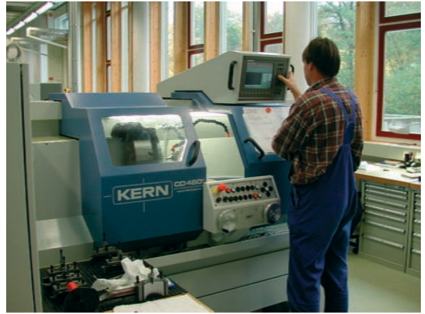
Abbildung 114: CNC-Zyklus-Drehmaschine, Neuerung in 2001. Mit dieser Maschine können komplizierte Formen wie z.B. Kugeln mit hoher Genauigkeit hergestellt werden.
