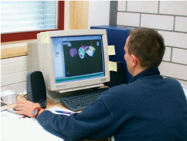
Abbildung 117: CAD-Arbeitsplatz in der Konstruktionsabteilung. Am AIP wird ausschließlich in 3D konstruiert. Z.Zt. wird das Autodesk Inventor System auf schnellen PC Workstations eingesetzt.
