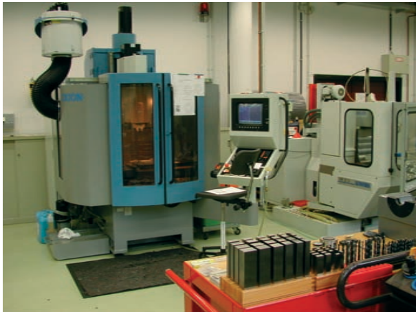
Abbildung 112: IXION CNC-Fräsmaschine, wird als "Arbeitspferd" für die Bearbeitung vieler Einzelteile verwendet. Hinten rechts: MICRON Präzisionsfräsmaschine für erhöhte Anforderungen.
