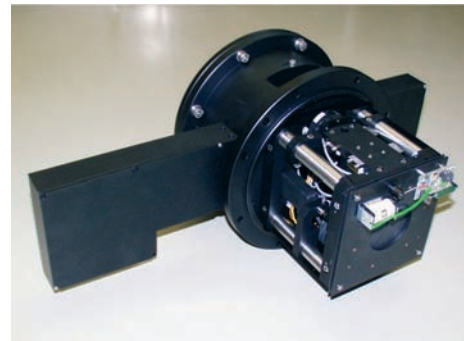
Abbildung 116: Gegenüberstellung des Endprodukts zur Computerdarstellung in Abb 113. Sämtliche Einzelteile wurden in der Werkstatt des AIP gefertigt, montiert und mit der Elektronik integriert.
