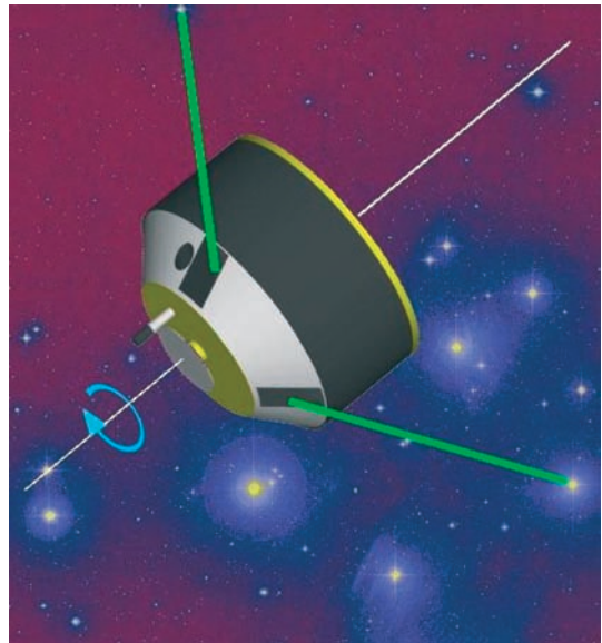
Abbildung 96: Darstellung der Abtastung des Himmels durch DIVA. Der Satellit rotiert um seine Achse und misst die Sternpositionen in zwei Gesichtsfeldern.
