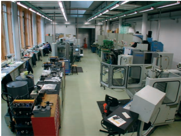
Abbildung 111: Feinmechanische Werkstatt mit modernen Bohr-, Dreh- und Fräsmaschinen. Im Hintergrund ist der Übergang zur Montagehalle zu erkennen.
