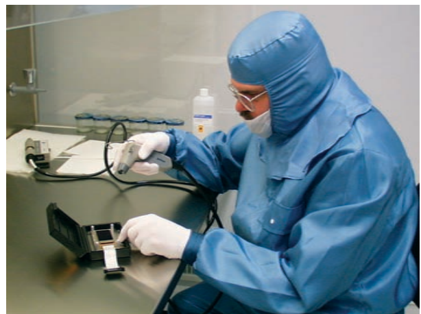
Abbildung 122: Im Reinraum der Klasse 4 steht eine staubgeschützte Arbeitsumgebung für den Umgang mit besonders empfindlichen Optiken, CCDs und IR Detektoren usw. zur Verfügung.
