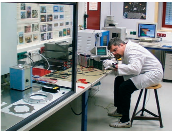
Abbildung 119: Im Detektorlabor sowie im angrenzenden Reinraum (Bild rechts) erfolgen die Integration und Tests von Detektorsystemen, hier z.B. die Elektronik einer CCD-Kamera.
