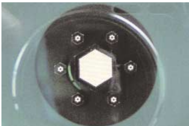
Neues Interface für PPAK: ein hexagonales Faserbündel, das ein Feld von 65'' \times 74'' darstellt. Die sechs kleineren Bündel messen den Hintergrund in der Nähe des Objekts, um ihn abziehen zu können.
