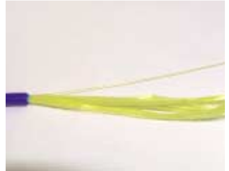
Ummantelte Glasfaser zum Einsatz unter variabler mechanischer Belastung bei PEPSI.
